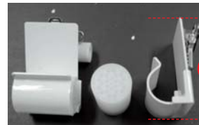
▲Ox濃度の空間分布のシミュレーション結果(5月平均) ▼パッシブサンプラー(簡易測定) ※パッシブサンプラーは、小型で電源がいらず、暴露時間に応じたOx濃度が簡易に測定できる。
