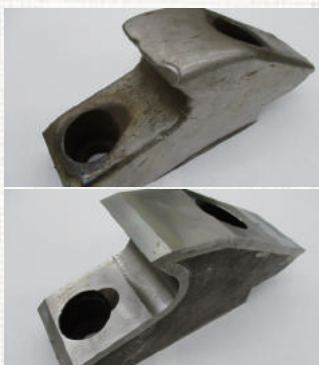
▲リユース前(上)後(下)の破碎機の刃物。当初は人力で溶接していましたが、摩擦状況の異なるそれぞれの刃に自動的に金属を盛る技術を開発し、一定の品質で刃を再生できるように
